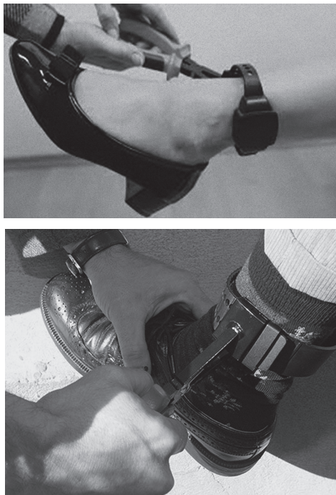
Obrázok č. 2: Upevnenie elektronického náramku na členok kontrolovanej osoby
