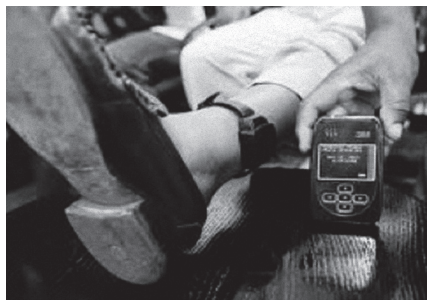
Obrázok č. 5: Zariadenie na určenie aktuálnej geografickej polohy kontrolovanej osoby
